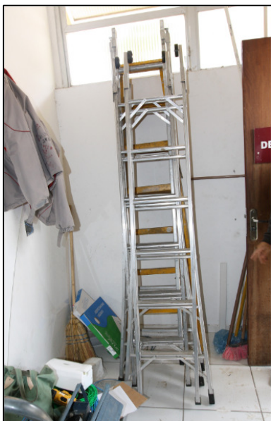
Foto 51 – Utilização de escadas de material não isolante (alumínio) para manutenção. Acondicionamento de material e ferramentas de forma inadequada.
