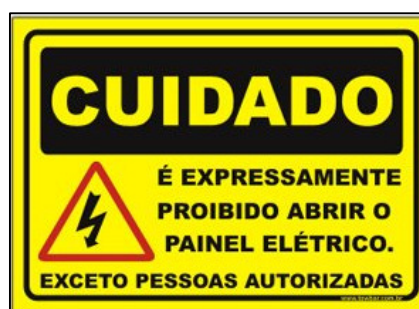
Figura 18 - Recomendação de sinalização externa dos quadros elétricos
