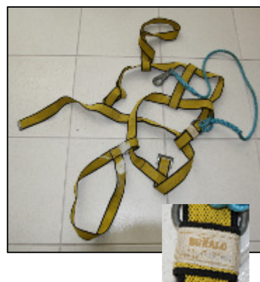
Foto 50 - Cinto inadequado para o tipo de serviço executado.
