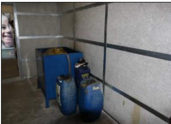
Foto 64 - Manuseio e armazenamento inadequado de combustíveis.
